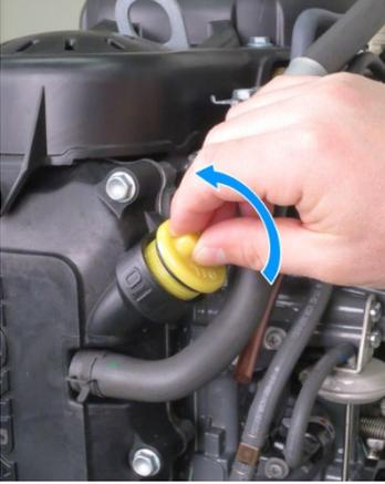
7. Nehmen Sie den Deckel der Öleinfüllöffnung ab.
