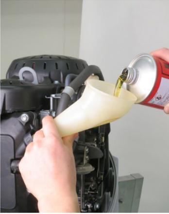
10. Füllen Sie das empfohlene Öl bis zur oberen Grenzmarkierung am Messstab nach. Nicht überfüllen. Zu viel Motoröl kann den Motor beeinträchtigen.
