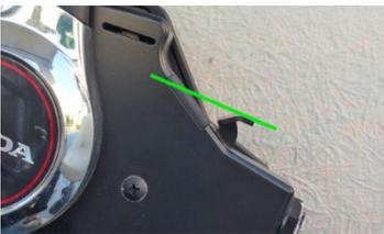
6. Typ mit Ruderpinne: Richten Sie die „Start“-Markierung am Gasdrehgriff auf die „▲“-Markierung am Pinnengriff aus.
