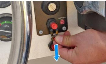
4. Entfernen Sie den Nothaltsschalterclip.
