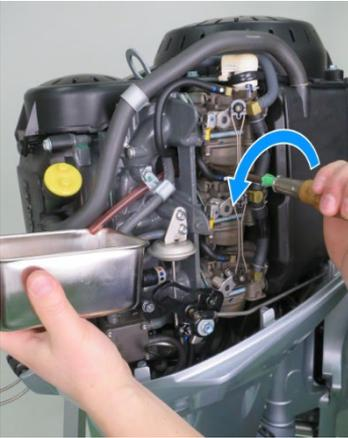
3. Lassen Sie den Kraftstoff aus allen Vergasern ab. Achten Sie darauf, dass die Ablassschrauben nach dem Entleeren wieder fest angezogen werden.
