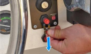
1. Entfernen Sie den Nothaltschalterclip.
