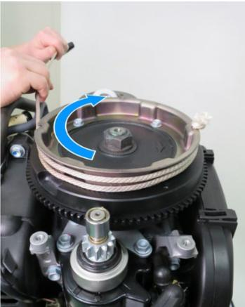
8. Wickeln Sie das Notstartseil im Uhrzeigersinn um das Schwungrad entlang der Nut im Schwungrad.
