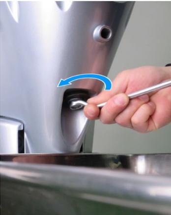
8. Stellen Sie einen geeigneten Behälter unter die Ölablassöffnung, entfernen Sie die Abdeckung der Motorölablassschraube und die Dichtungsscheibe. Lassen Sie das Altöl solange laufen, bis es nur noch heraustropft.
