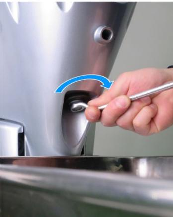
9. Montieren Sie nach dem Ablassen des Öls die Ablassschraube und die neue Dichtungsscheibe und ziehen Sie die Schraube fest an. Setzen Sie die Ablassschraubenabdeckung auf.
