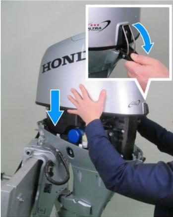
10. Montieren Sie die Abdeckung des Schwungrads nicht und bringen Sie die Motorabdeckung an. Schließen Sie die Befestigungsschnallen der Motorabdeckung.
