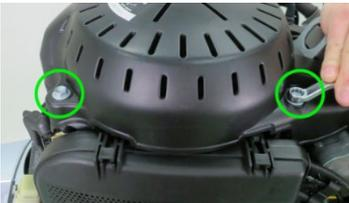
3. Entfernen Sie die vier Schrauben und die Abdeckung des Schwungrads.
