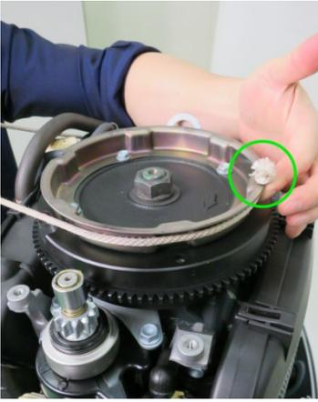
7. Setzen Sie das verknotete Ende der Notstartsnur in die Kerbe am Schwungrad.
