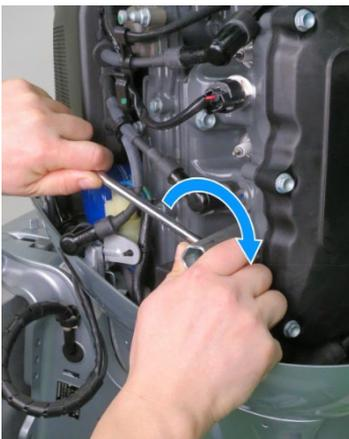
14. Drehen Sie die Zündkerzen vorsichtig von Hand ein, um ein Ausreißen des Gewindes zu vermeiden. Ziehen Sie die Zündkerzen nach dem Aufsitzen mit einer 1/8- bis 1/4-Drehung fest. Bringen Sie die Lichtmaschinenabdeckung an.
